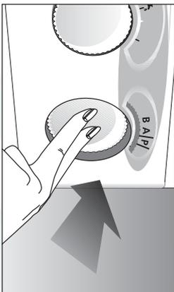
Установите нужную программу и температуру. Для того, чтобы повернуть ручку, слегка давите ее. Завершив регулировку, повторным нажатием верните ручку на место. Эта мера предосторожности не позволит детям играть с ручками управления машины.
