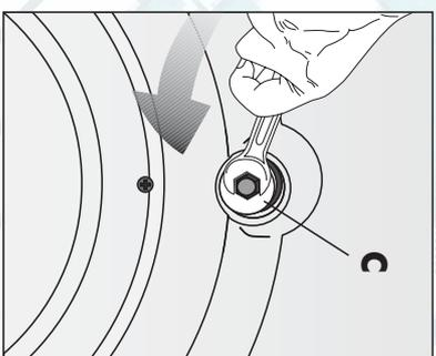
следует выворачивать против часовой стрелки до тех пор, пока их нельзя будет легко вытащить.
