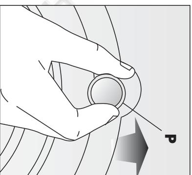
Отверстия для транспортировочных болтов необходимо закрыть прилегающими пластиковыми заглушками, имеющими обозначение "P", как показано на рисунке.
