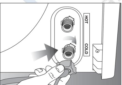
Подключение к источнику холодной воды производится с помощью шланга с синей отметкой, к источнику горячей воды — с помощью шланга с красной отметкой.
