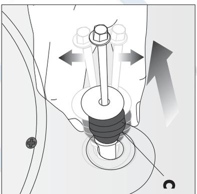
Удалите транспортировочные болты и резиновые втулки. Движение болтов вверх/ вниз и добавление небольшого количества промывочной жидкости облегчит удаление болтов.
