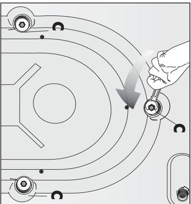
Перед установкой машины на место необходимо снять транспортировочные болты. Болты, на головках которых имеется обозначение "С",
