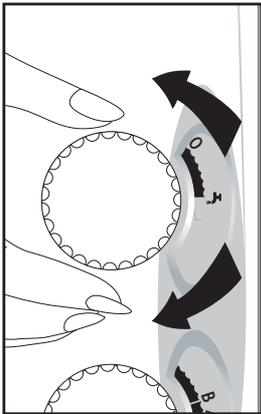
Поверните ручку термостата по часовой стрелке и установите ее на нужную температуру. Если ручка установлена на значок холодной воды "3", то стирка производится без подогрева. Поместите стиральный порошок и кондиционер в соответствующие отделения распределителя и закройте его.
